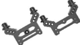
Vordere und hintere Stoßdämpfer- baugruppe
