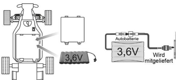
1. Trennen Sie das Batteriekabel vom Netzanschluss und entfernen Sie dann die Batterie aus dem Batteriefach.
