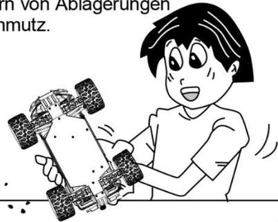
Tragen Sie Schmieröl auf die äußeren Metallteile auf.
