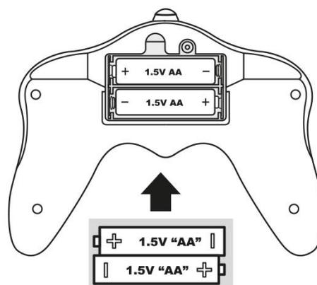
**Hinweis:** Die Batterie muss mit der richtigen Polarität eingesetzt werden.
