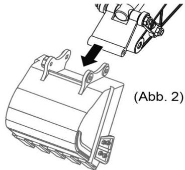
2. Montieren Sie die Teile am mittleren Arm, setzen Sie die Schraubenspikes ein und ziehen Sie die Schraubenmutter fest.
