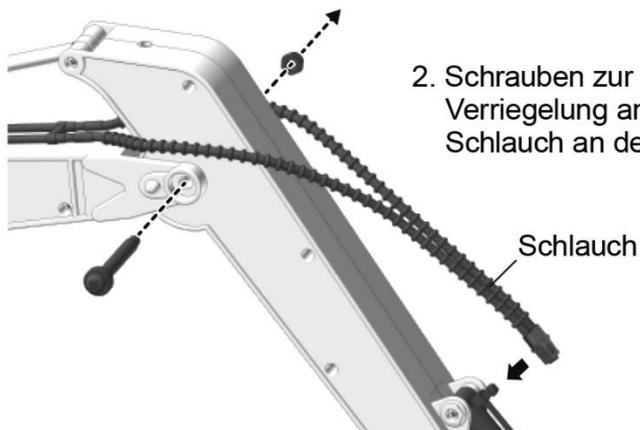
2. Schrauben zur Fixierung und Verriegelung anbringen und den Schlauch an den Zylinder anbringen.
