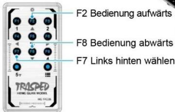
Drücken Sie zunächst die Taste „F7 links hinten wählen“ und verwenden Sie dann „F2 Bedienung aufwärts“ und „F8 Bedienung abwärts“, um die linke Hinterradschwinge nach oben und unten zu steuern.
