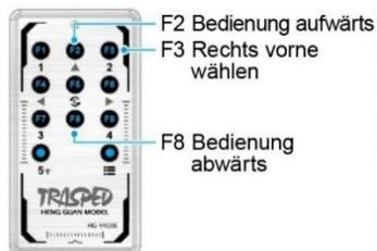
Drücken Sie zunächst die Taste „F3 rechts vorne wählen“ und verwenden Sie dann „F2 Bedienung aufwärts“ und „F8 Bedienung abwärts“, um die rechte Vorderradschwinge nach oben und unten zu steuern.
