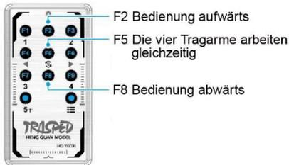
Drücken Sie zuerst „F5 die vier Tragarme arbeiten gleichzeitig“ und dann drücken Sie „F2 Bedienung nach oben“ und „F8 Bedienung nach unten“ um die vier Tragarme nach oben und unten gleichzeitig zu bewegen.
