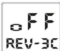
**Einrichten des 3. Kanals.** Drücken Sie die linke Taste der Menüfunktion (<) einmal unter dem Hauptmenü und dann zweimal die rechte Taste (>) der Menüfunktion, bis Sie\*\*\* REV-3C sehen. Drücken Sie die linke Taste (+) oder die rechte Taste (-) der Menüfunktion DATA, um ein/aus zu wählen, (der Bildschirm zeigt OFF TEV-3C).
