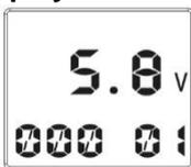
Schalten Sie den Sender an, Sie hören einen „Beep“ Ton (1 x Piep), und der Anzeigemodus zeigt die voreingestellten Standardparameter und den BATT-Statusmodus (Hauptmenü)
