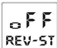
**Einrichten der Lenk-Servo-Richtung.** Drücken Sie die linke Taste (<) oder die rechte Taste (>) der Menüfunktion. Drücken Sie einmal unter Hauptmenü, bis Sie "\*\*\* REV-ST" sehen, dann drücken Sie die linke Taste (+) oder die rechte Taste (-) der DATA-Funktion, um ein/aus zu wählen, (der Bildschirm zeigt OFF REV-ST an).
