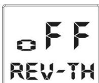
**Einrichten der neutralen Gasdrehzahl-Position.** Drücken Sie die linke Taste der Menüfunktion (<) einmal unter dem Hauptmenü und dann zweimal die rechte Taste (>) der Menüfunktion, bis Sie\*\*\* REV-TH sehen. Drücken Sie die linke Taste (+) oder die rechte Taste (-) der DATA-Funktion, um die Option Ein/Aus zu wählen (der Bildschirm zeigt OFF TEV-TH).
