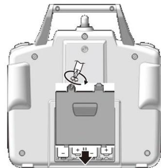
**Hinweis:** Die Batterie muss mit der richtigen Polarität eingesetzt werden.
