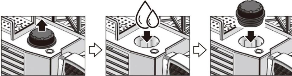
1. Entfernen Sie den Deckel des Wassertanks am Auto.
