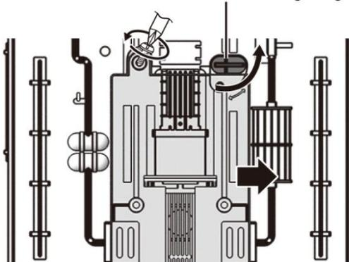
2. Verbinden Sie den Lithium-Ionen-Akku mit dem Stromanschluß des Autos und legen Sie ihn in die Batteriebox. (Abb. 2)
