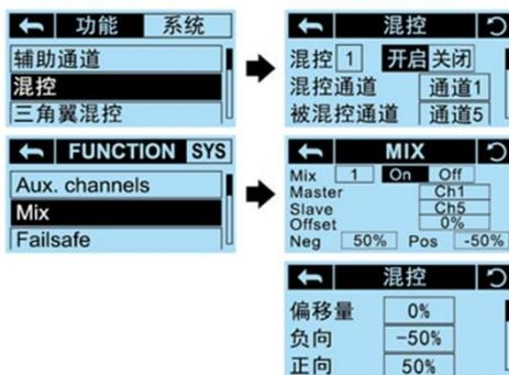
Das Steuersignal eines Kanals wird mit dem eines anderen Kanals zusammengeführt.
