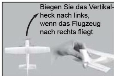
Biegen Sie das Vertikalheck nach links, wenn das Flugzeug nach rechts fliegt
