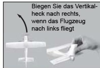
Biegen Sie das Vertikalheck nach rechts, wenn das Flugzeug nach links fliegt
