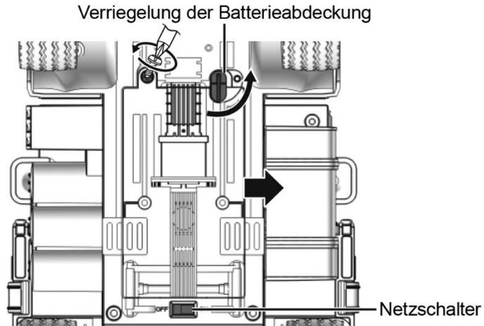
2. Schließen Sie die Lithium-Ion-Batterie an den Stromanschluss des Fahrzeugs an und legen Sie sie dann in den Batteriekasten. (Abb. 2)
