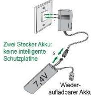
① Der Stecker des Ladegeräts wird in die Steckdose gesteckt, das grüne Licht am Ladegerät (Strom-/Ladeanzeige) leuchtet. Auch hier wird der Stromausgangsanschluss des Ladegeräts verwendet, um ihn mit dem wiederaufladbaren Akku zu verbinden. Zu diesem Zeitpunkt wird das grüne Licht auf dem Ladegerät in das rote Licht auf dem Ladegerät umgewandelt. Ein grünes Licht zeigt an, dass der Ladevorgang beendet ist. Die Ladezeit beträgt ca. 2 Stunden.
